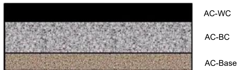
Gambar 2. Komponen Perkerasan Lentur dan ukuran Tebal Laston
