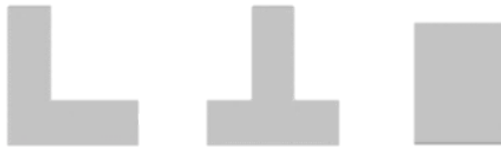
Gambar 2. Kolom Bentuk L,T, dan Persegi (Pratama, 2021)
